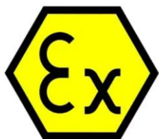
Rysunek 4 Oznaczenie Ex / cecha przeciwybuchowa na urządzeniach spełniających wymagania ATEX
